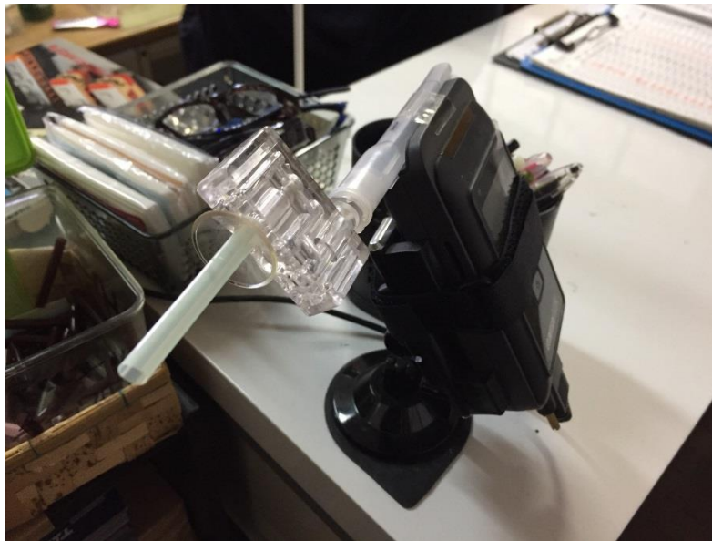
事務所に設置しているアルコール検知器
